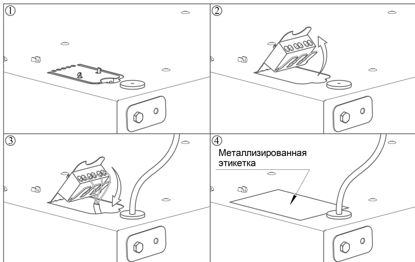
Рисунок 3 - Подключение светильника ДВО12 VDG к сети
