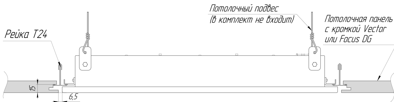
Рисунок 2 - Схема установки светильника ДВО12 VDG
