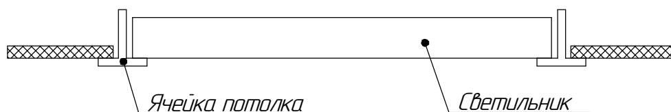
Рисунок 2 - Схема установки светильника
