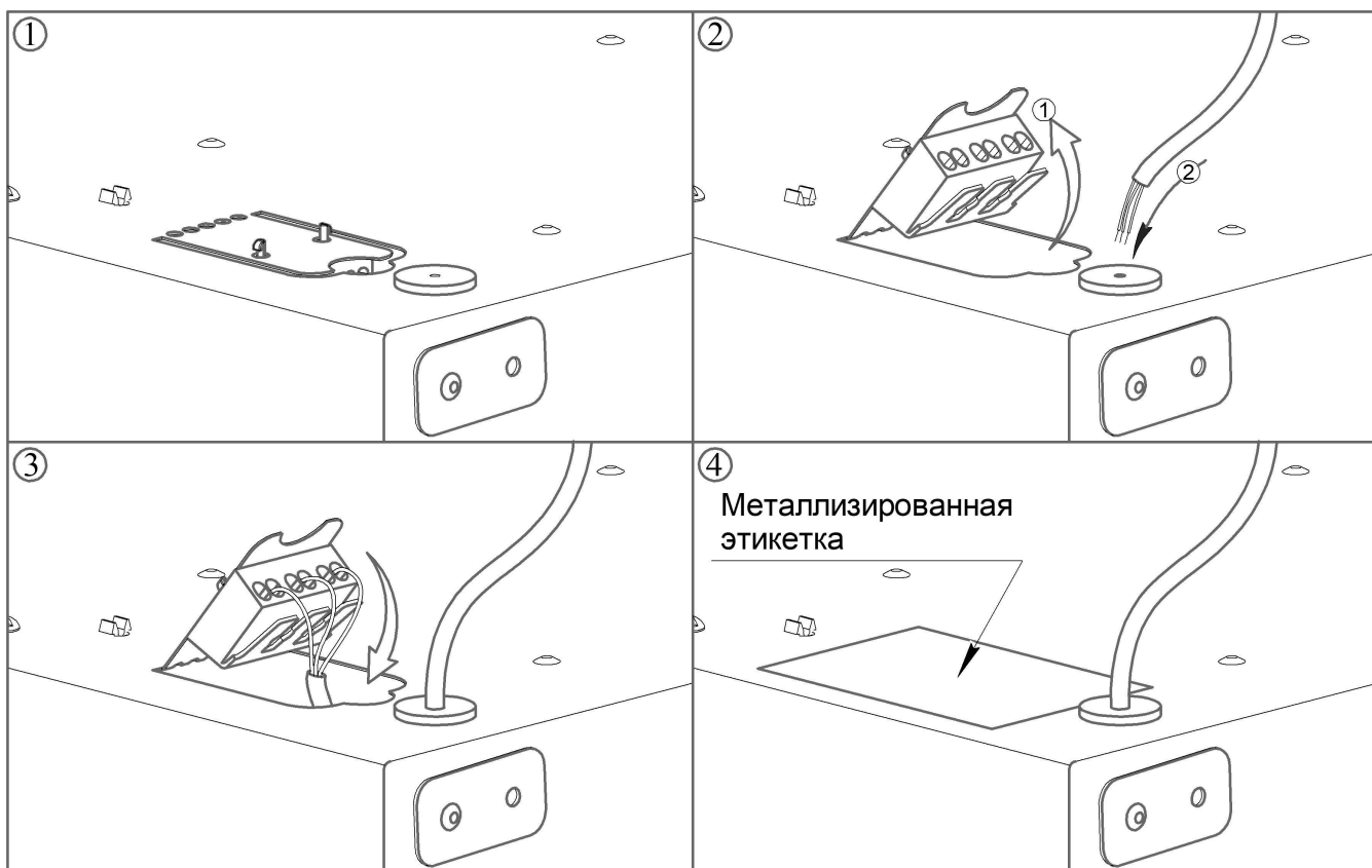
Рисунок 3 - Подключение светильника ДВО12 VCF к сети
