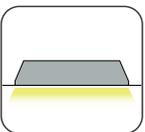
Встраиваемый монтаж в потолки «АРМСТРОНГ», ячейка 600х600мм. Устанавливается взамен или дополнительно к имеющимся светильникам. Также может быть установлен в потолки «ГРИЛЬЯТО».
