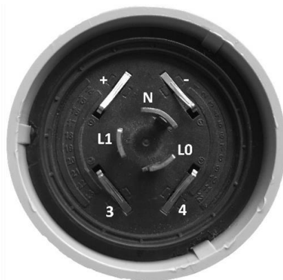
Рисунок 2 Внешний вид контроллера, вид снизу, распиновка
