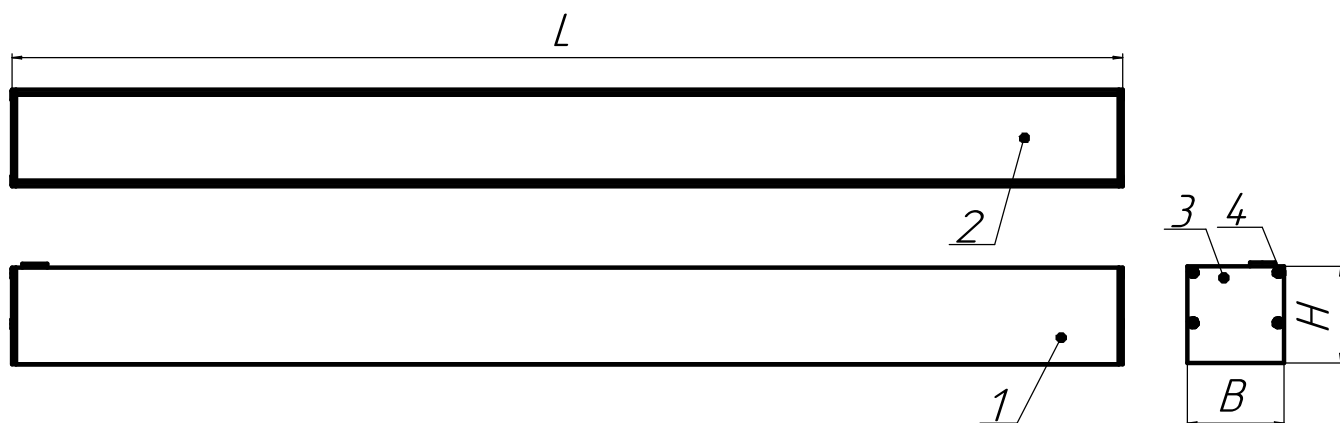
Рисунок 1 - Общий вид светильника серии ДПО02 5050 1 - корпус с источником питания и светодиодными модулями, 2 - рассеиватель, 3- крышка, 4- саморезы.
