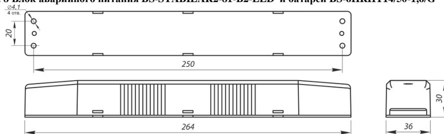
Рис. 9 Блок аварийного питания BS-STABILAR2-81-B2-LED BOX IP30
